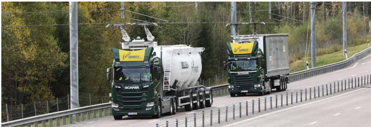
I världens första elvägsprojekt i sitt slag kör två eldrivna Scania lastbilar på allmän väg med konduktiv teknik utvecklad av Siemens.
